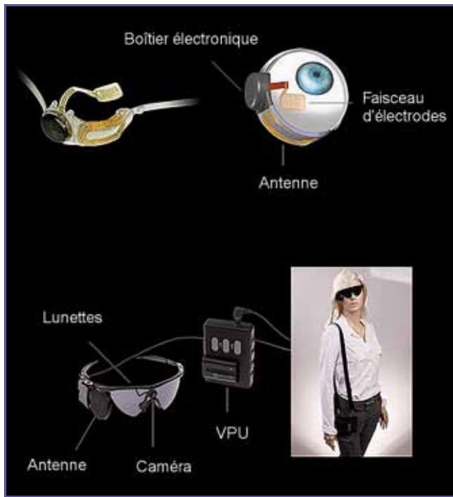
FIG. 1 : Système de prothèse rétinienne Argus II. Une caméra vidéo miniature logée dans les lunettes du patient filme une scène. La vidéo est envoyée à un petit ordinateur porté par le patient (unité de traitement vidéo ou VPU) qui la traite et la transforme en instructions renvoyées aux lunettes via un câble. Ces instructions sont transmises à une antenne dans l'implant par le biais d'une connexion sans fil. Les signaux sont ensuite envoyés au faisceau d'électrodes qui émet de petites impulsions électriques. Ces impulsions "contournent les photorécepteurs endommagés" et stimulent les cellules restantes de la rétine, qui transmettent les informations visuelles le long du nerf optique au cerveau, créant la perception de formes lumineuses. Un apprentissage est nécessaire pour interpréter ces formes visuelles (source : http://2-sight.eu/fr ).
